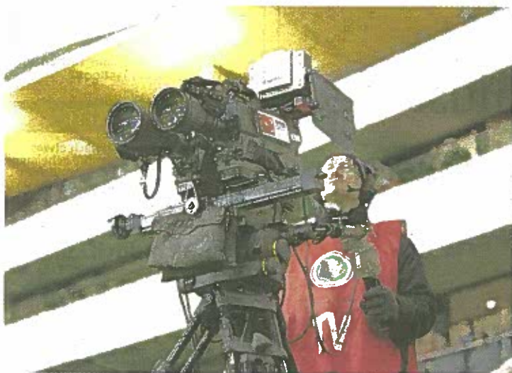
3D-Kameras haben zwei Objektive, die wie Augen fokussieren.
